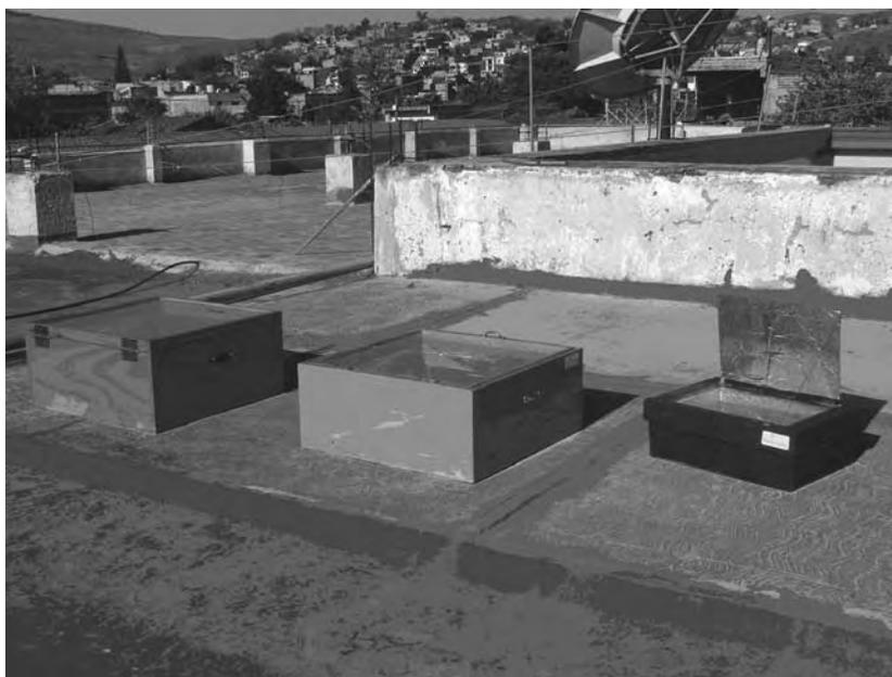
Figura 1. Análisis comparativo de la dinámica de temperaturas de tres modelos de estufa solar.
